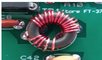
DETAIL TRANSFO HF AVEC TORE T-37-2
